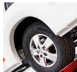
Haltbarkeit Fahrtst. Der Beständigkeitstest wird auf einem Rüttelstand durchgeführt und entspricht einer normalen Fahrleistung von 100.000 km.
