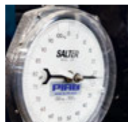
Måleinstrument for drag.
