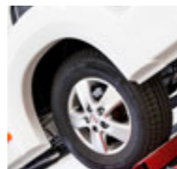
Holdbarhetstest simuleres i en vibrasjonsbenk og tilsvarer 10 000 mil normal kjøring.
