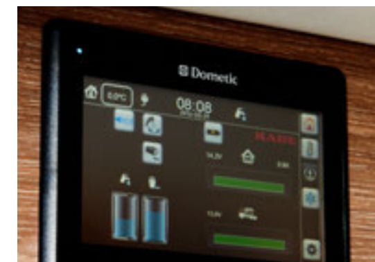
De actuele statusinformatie van het verswaterniveau, het grijswaterniveau en de accu spanning worden op overzichtelijke wijze aangegeven.
