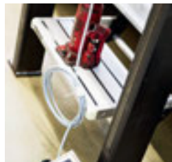
Met behulp van druk wordt de sterkte van de producten getest.
