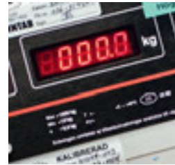
Weegschalen voor het balanceren en optimaliseren van de gewichtsverdeling over de assen.
