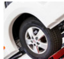
Op een schudbank wordt de soliditeit getest, deze simulatie komt overeen met 100.000 km normaal rijden.
