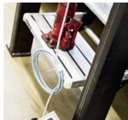
Trykk benyttes for å teste produktene holdfasthet.
