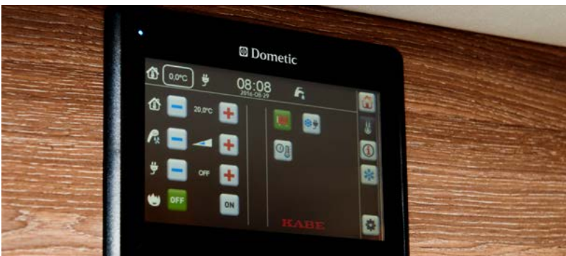
All informasjon og styring angående varme vises på en egen side. Her hever og senker du varmen smidig med digitale skyvebrytere.
