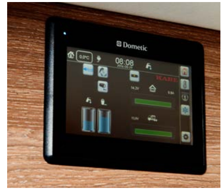
Aktuell statusinformasjon om ferskvannsnivå, spillvannsnivå og batterispenning vises på en oversiktlig måte.
