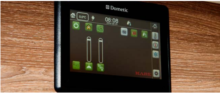
På startsideen vises alle knapper for belysning og digitale skyvebrytere for dimmer. Her ser du også temperatur, både ute og inne, og klokke.
