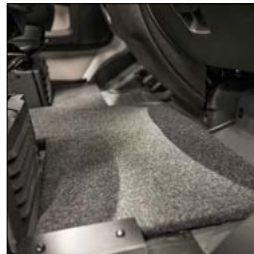
Verwarmingsmat in de cabine met verwarming in de instap Warmtewisselaar Verwarmingspakket onder passagiersstoel
