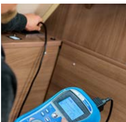
Het elektrische systeem en andere belangrijke functies worden gecontroleerd voordat de caravans en campers onze fabriek verlaten.
