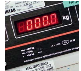
Weegschalen voor het balanceren en optimaliseren van de gewichtsverdeling over de assen.
