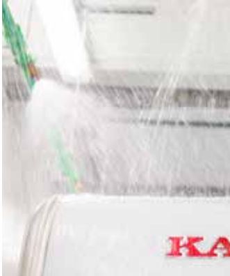
In de regenkamer worden de campers onder hoge druk bespoten.
