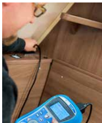
Het elektrische systeem en andere belangrijke functies worden gecontroleerd voordat de caravans en campers onze fabriek verlaten.
