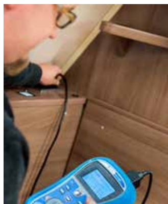
Die elektrische Anlage und andere wichtige Funktionen werden kontrolliert, bevor die Wohnwagen und Wohnmobile die Fabrik verlassen.
