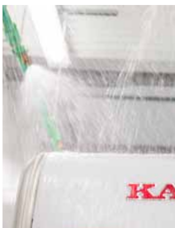
I regnkammeret sprutes det vann på bobilene under høyt trykk.
