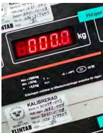
Vekter for å balansere og optimere vektfordeling mellom aksler.
