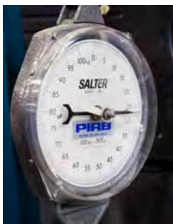
Måleinstrument for drag.
