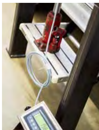
Trykk benyttes for å teste produktens holdfasthet.
