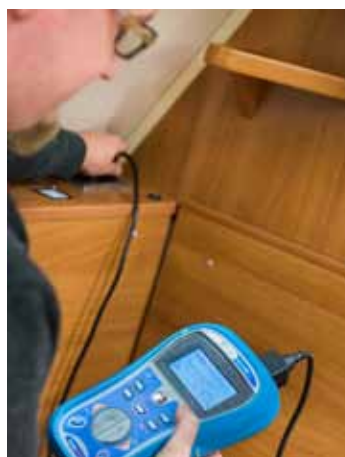
Elsystemet og andre viktige funksjoner kontrolleres før campingvognene og bobilene får forlate fabrikk.
