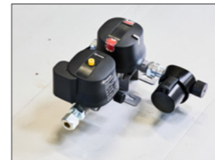
Duo Control. Duo Control har innebygd automatisk gasskobler, reduksjonsventil og kollisjonssensor som utløses ved sammenstøt med en G-kraft på 3,5 G. Gasstilførselen stenges da av med en gang for å unngå gasslekkasje. Duo Control er godkjent i hele Europa for å ha gassen tilkoblet under kjøring.
