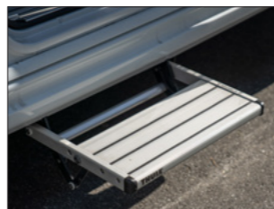
Elektrisk, fast montert innsteg
