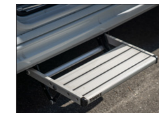
Elektrisk, fast montert innsteg
