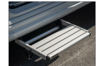
Elektrisk, fast montert innsteg
