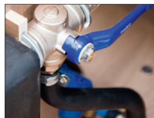
Direktabfluss; als Bypass für den Abwassertank (Serienmäßig im Imperial)
