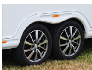
Tandemachse für Royal 630 GLE bei bestimmten Ausführungen. Weitere Anwendungen modellabhängig.
