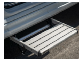
Elektrisk, fast montert innsteg
