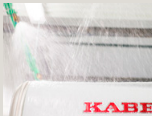
REGNKAMMER. I regnkammeret sprutes det vann på campingvognene under høyt trykk.
