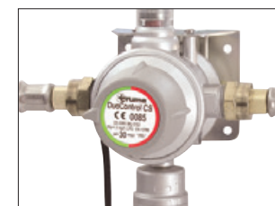
Duo Control. Duo Control har innebygd automatisk gassomkopler, reduksjonsventil og kollisjonssensor som utløses ved sammenstøt med en G-kraft på 3,5 G. Gasstilførselen stenges da av med en gang for å unngå gasslekkasje. Duo Control er godkjent i hele Europa for å ha gassen tilkopledd under kjøring.
