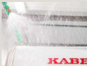
SADEKAMMIO. Sadekammiossa matkailuvaunujen päälle ruiskutetaan vettä kovalla paineella.
