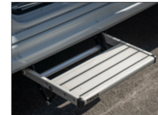
Sähkötoiminen, kiinteästi asennettu porras
