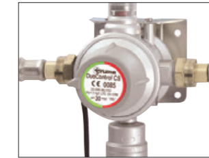
Duo Control. Duo Control on sisäänrakennettu yhdistetty automaattinen kaasupullonvaihtaja, paineenalennusventtiili ja törmäystunnistin, joka laukeaa voimakkuudeltaan 3,5 G:n yhteentörmäyksessä katkaisten välittömästi kaasuvirtauksen kaasuvuodon estämiseksi. Duo Control on hyväksytty kaikkialla Euroopassa varusteeksi, jolla kaasua saa käyttää ajon aikana.
