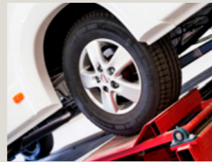
SLIDSTYRKETEST KØRSEL. Holdbarhedstests simuleres på et rystebord, der svarer til 100.000 km normal kørsel.
