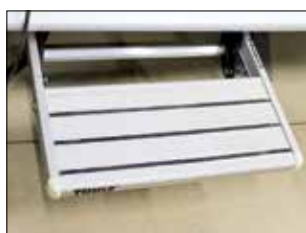
Elektrisk, fast montert innsteg
