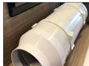
SmartVent. Voor Royal- en Imperial-modellen is nu een nieuw, slim ventilatiesysteem optioneel beschikbaar. De ventilatie wordt automatisch gestuurd, afhankelijk van de temperatuur, de hoeveelheid kooldioxide en de koolwaterstoffen in de lucht. Het systeem verbruikt bij koud weer 7 procent minder energie in vergelijking met traditionele ventilatie en de inkomende lucht is van betere kwaliteit. Een speciaal filter vermindert de hoeveelheid deeltjes in de lucht en als de lucht verontreinigd is wordt deze sneller ververst.
