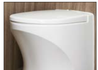
Cinderella-polttokäymälä. Cinderella on moderni ja ympäristöystävällinen käymäläratkaisu, joka tarjoaa paljon kapasiteettia ja hyvän toimintavarmuuden. Se polttaa paperin, virtsan ja ulosteet korkeassa lämpötilassa noin kupilliseksi tuhkaa yhden henkilön kuukauden käymäläkäyntien jäljiltä. Puhdasta, hygieenistä ja hajutonta. (TDL-Mallit Royal, Imperial ja Hacienda)
