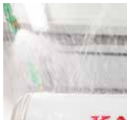
Sadekammio. Sadekammiossa matkailuvaunujen päälle ruiskutetaan vettä kovalla paineella.
