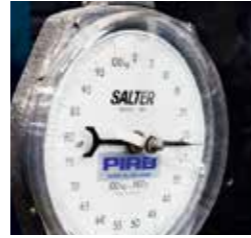
Veto. Vetoluujuden mittauslaite.
