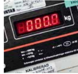
Optimoitu painojakauma. Vaa'at akselien välisen painonjakauman tasapainottamiseksi ja optimoimiseksi.
