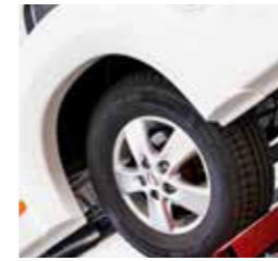
Haltbarkeit Fahrttest. Der Beständigkeitstest wird auf einem Rüttelstand durchgeführt und entspricht einer normalen Fahrleistung von 100.000 km.
