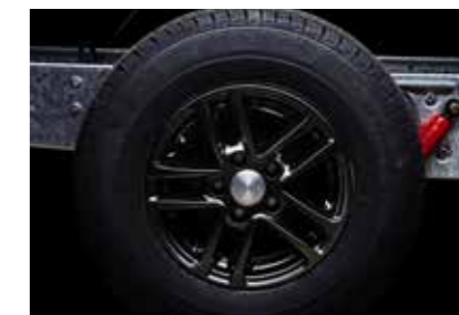
Reifen und Kupplung. Die Reifen für Wagen mit Einzelachse sind aus 8 Schichten aufgebaut. Die doppelachsigen Wagen haben 14-Zoll-Niedrigprofilreifen. Alle Wohnwagen haben eine Reibungskupplung.
