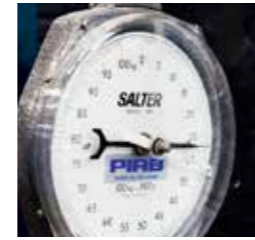
Anhängerkupplung. Zugprüfinstrument für Wohnwagen.
