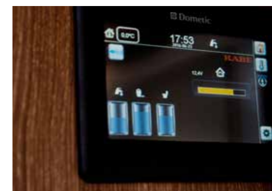
Aktuelle Statusinformationen zu Frisch- und Grauwasserstand sowie die Batteriekapazität werden übersichtlich präsentiert.
