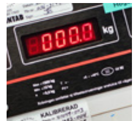
Optimera viktfordelning. Vågar för att balansera och optimera viktfordelning mellan axlar.
