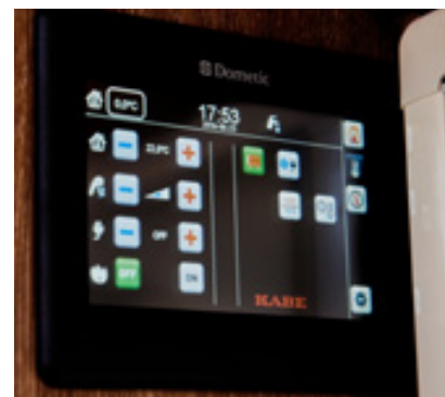
All information och styrning gällande värme visas på en egen sida. Här höjer och sänker du värmen smidigt med digitala skjutreglage.
