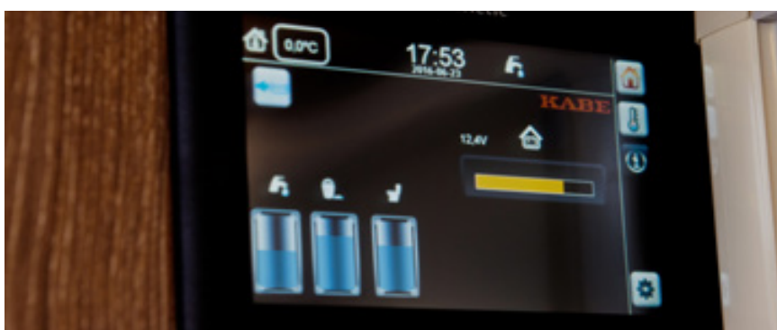
Aktuell statusinformation om färskvattennivå, gråvattennivå och batterispänning visas på ett överskådligt sätt.
