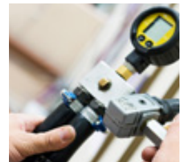
Gasol. Gasolsystemet trycktestas.
