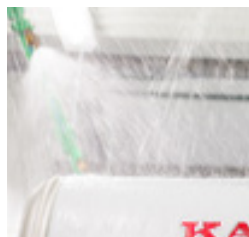
Regnkammare. I regnkammaren besprutas husvagnarna under högt tryck.
