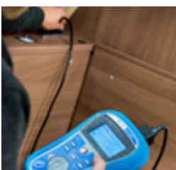
Elsystemet. Elsystemet og andre viktige funksjoner kontrolleres før campingvognene og bobilene får forlate fabrikk.
