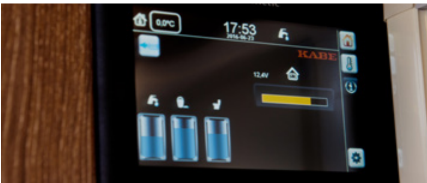
Aktuell statusinformasjon om ferskvannsnivå, spillvannsnivå og batterikapasitet vises på en oversiktlig måte.
