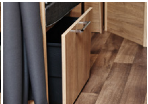
Dinette-skuffen i midtgruppen sklir praktisk i to rullleskinner. En nyhet for året.
