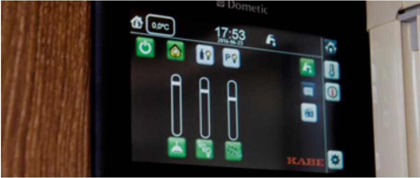
På startsiden vises alle knapper for belysning og digitale skyvebrytere for dimmer. Her ser du også temperatur, både ute og inne, og klokke.
