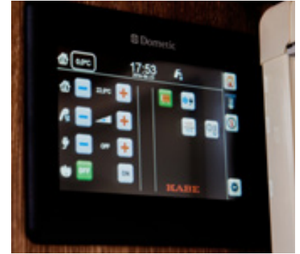
All informasjon og styring angående varme vises på en egen side. Her hever og senker du varmen smidig med digitale skyvebrytere.
