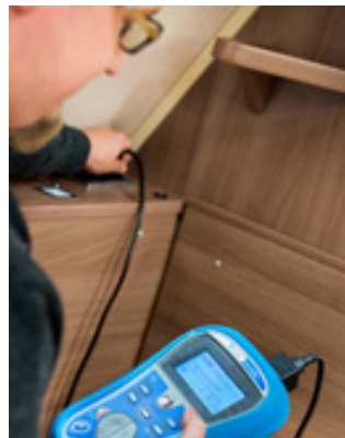
Sähköjärjestelmät ja muut tärkeät toiminnot tarkastetaan, ennen kuin matkailuvaunut ja -autot toimitetaan tehtaalta.
