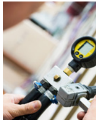
Kaasujärjestelmälle tehdään painekoe.
