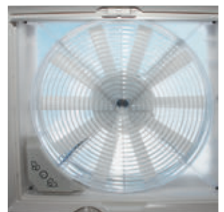
TAKLUKE MED TOVEIS VIFTE (X0222) KABE AIR VENT MED TERMOSTAT (SOVEROM) (X0228)
