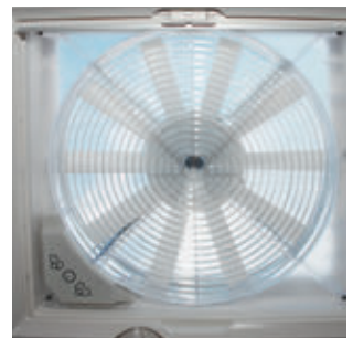
KATTOLUUKKU SISÄÄN- RAKENNETULLA PUHALTIMELLA (X0222) KABE AIR VENT TERMOS- TAATILLA (MAKUuhuONE) (X0228)
