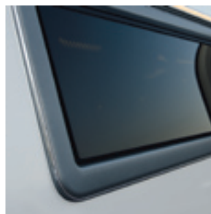
Mørktonede vinduer Beskytter mot innsyn samtidig som de skygger mot sterk solinnstråling.
