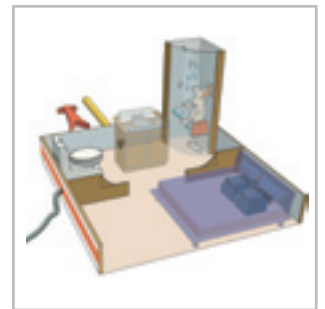
Tilknytning kommunalt vann/avløp Spillvann fra kjøkken og vaskerom pumpes ut. Vann fra toalettanken ledes dessuten gjennom en innebygd kvern for å kunne ledes ut til campingplassens avløpsnett.
