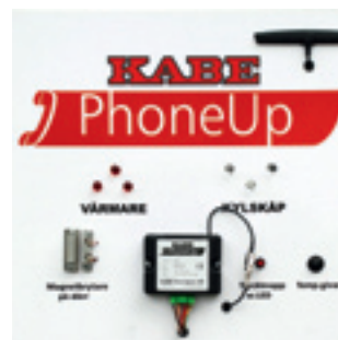
Phone Up GSM-basert alarm via mobiltelefon. Styring av varme og kjøleskap, overvåking av ytterdør, spenningsnivå og temperatur (standard i Hacienda).
