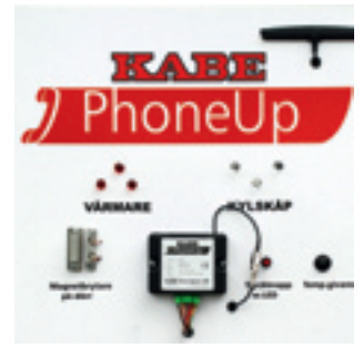
Phone Up GSM-pohjainen hälytin matkapuhelimen kautta. Lämmityksen ja jääkaapin ohjaus, ulko-oven, jännitetaso ja lämpötilan valvonta (vakiona Hacienda).
