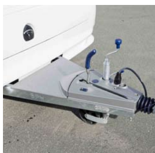
Dækkappe (X0269) Dækkappe med fodtrin passer fint over trækket. Kan tåle, at man står på den.
