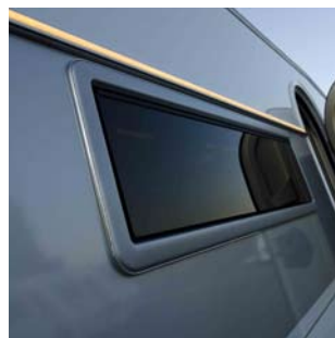
Mørktonede vinduer Forhindrer, at man kan se ind i vognen, og skygger for stærkt sollys. Vindue bagende 700 eller 1.000 mm.
