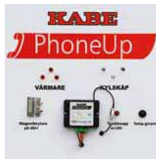
Phone Up GSM-basert alarm via mobiltelefon. Styring av varme og kjøleskap, overvåking av ytterdør, spenningsnivå og temperatur.
