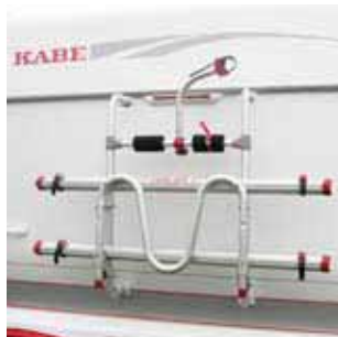
Sykelholder (X0061) Monteres på bakgavlen. Tåler vekt opp til 50 kg (2 sykler). Skvettlapp (X0088) bak hjulpar.
