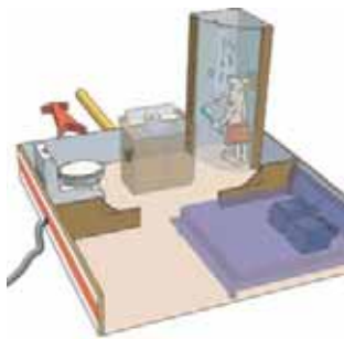
Tilknytning kommunalt vann/avløp Gråvannet fra kjøkken og vaskerom passerer gjennom toalettets kasset-tank før det, ved hjelp av en pumpe med innebygd "kvern", føres over i campingplassens avløpsnett.
