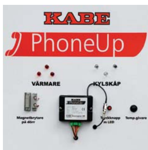
Phone Up GSM-baseret alarm via mobiltelefon. Styring af varme og køleskab, overvågning af yderdør, spændingsniveau og temperatur.
