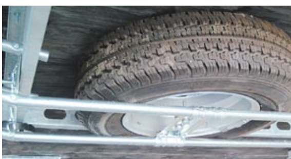
Ersatzradhalter X0063 unter dem Fahrwerk.
