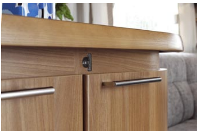
Eine Zentralverriegelung verhindert, dass sich die Schubladen unterwegs öffnen.
