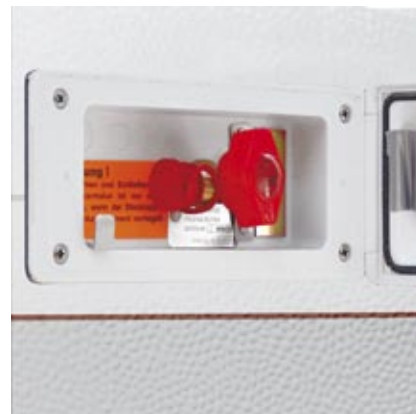
Gasanschluss außen Für Gasgrill im Freien.
