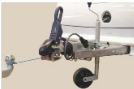
Puller Winch X0204 Til sikker tilkobling. Puller Winch passer til de fleste kuglekoblinger og manøvreres ved hjælp af en nøgle med 17 mm hylster.
