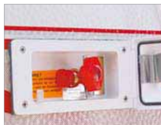
Gasanschluss außen Für Gasgrill im Freien.
