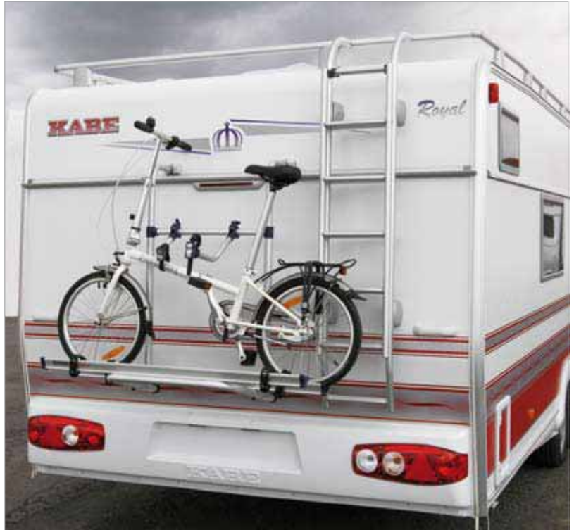
Dachreling mit Klappleiter. X0150 Klässt sich mit einem Fahrradhalter kombinieren. Zwischenstrebe für Dachständer X0158 Fahrradhalter X0061 Wird an die Rückwand montiert. Tragfähigkeit bis 50 kg (2 Fahrräder). Spritzschutz X0088 Hinter dem Radpaar.
