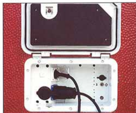
Den utvändiga elboxen innehåller 220V in- och uttag, 12V uttag samt centralantennanslutning. (R, Å)
