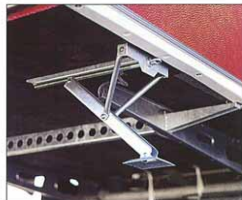
Chassi och stödben är helgalvaniserade och dimensionerade att tåla hårda påfrestningar. (R, S, Ä)
