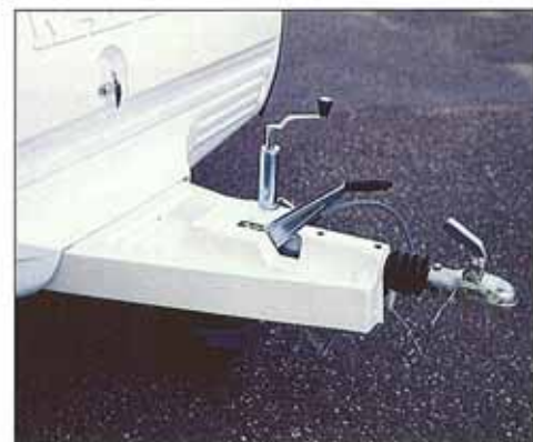
Kapslat drag i ABS håller utsatta delar rena från smuts. (Ä)
