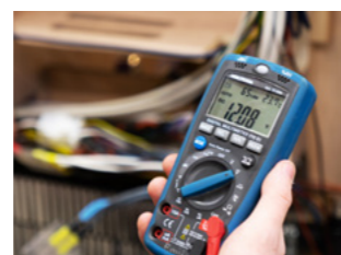
Het elektrische systeem en andere belangrijke functies worden gecontroleerd voordat de caravans onze fabriek verlaten.
