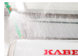
In de regenkamer worden de caravans onder hoge druk bespoten.
