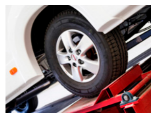
Op een schudbank wordt de soliditeit getest, deze simulatie komt overeen met 100.000 km normaal rijden.
