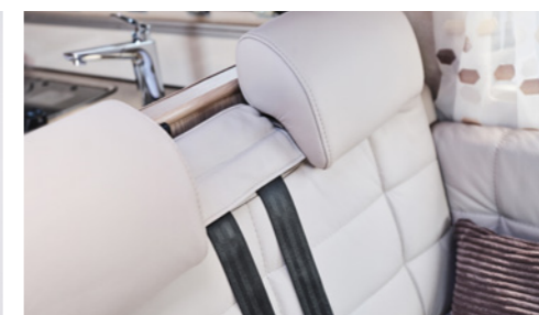
Die Dinette mit zwei Gurtplätzen ist so konstruiert, dass das Sitzpolster bei einem Crash nicht verrutscht.
