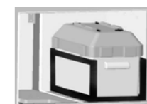
Die Aufbauabatterie ist in einem stabilen Stahlrahmen verankert, der die Batterie im Falle eines Unfalls sicher an ihrem Platz hält.
