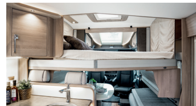
Under buen i taket, rett bak førerhuset, skjuler det seg en elektrisk nedsenkbar takseng
