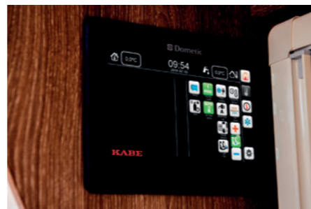
All informasjon og styring angående varme vises på en egen side. Her hever og senker du varmen smidig med digitale skyvebrytere.
