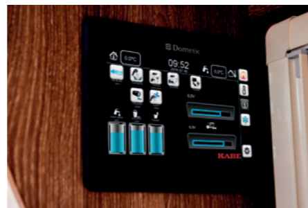
Aktuell statusinformasjon om ferskvannsnivå, spillvannsnivå og batterispenning vises på en oversiktlig måte.
