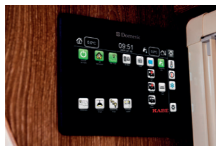
På startside vises alle knapper for belysning og digitale skyvebrytere for dimmer. Her ser du også temperatur, både ute og inne, og klokke.
