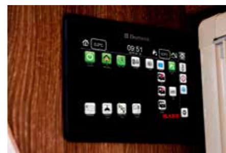
Aloitussivulla näet kaikki valaistuksen painikkeet ja himmentimen digitaaliset liukusäätimet. Tästä näet myös ulko- ja sisätilojen lämpötilan sekä kellon.
