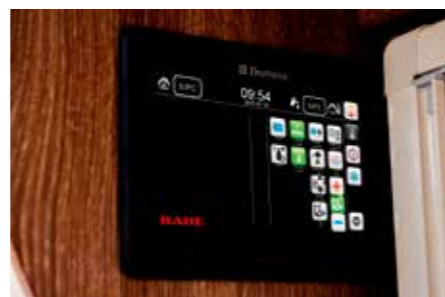
Alle oplysninger og styringen vises på en separat side. Her skrues du nemt op og ned for varmen med den digitale skyder.
