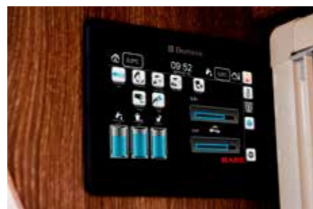
Aktuel statusinformation om friskvandsniveau, gråvandsniveau og batterispænding vises på en overskuelig måde.
