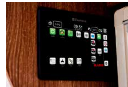
Auf der Startseite werden alle Knöpfe für die Beleuchtung sowie die digitalen Schieberegler für die Dimmerfunktionen angezeigt. Hier können Sie auch Außen- und Innentemperatur sowie die Uhrzeit ablesen.
