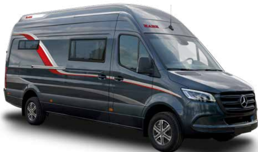
Der KABE Van hat Heckantrieb, kann aber auch mit Allradantrieb bestellt werden. Der Motor ist ein Vier-Zylinder Dieselmotor von Mercedes der Umweltklasse Euro-6 mit 163 PS. Oben rechts: In dem derzeitigen Bauteilewerk wird die neue Produktionslinie für den Van installiert. Unten: Mikael Blomqvist, technischer Leiter und stellvertretender Geschäftsführer von KABE.
