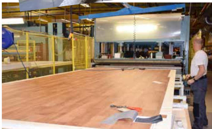
Bundpladen limes og presses sammen.
