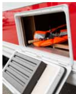
Lasteluke med luftkanaler under sengen
