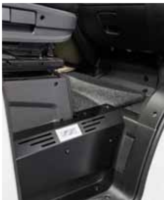
Ohjaamossa on patterit molemmissa astinkoteloissa.
