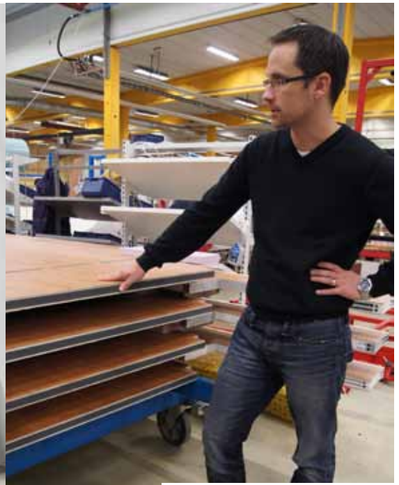
Daniel Blom, tekninen johtaja, tarkastaa juuri valmistuneet lattialämmityksellä varustetut lattiat.
