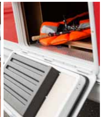
Uuden tavaraluukun ympärillä on lämmitys sekä ilmakehät.
