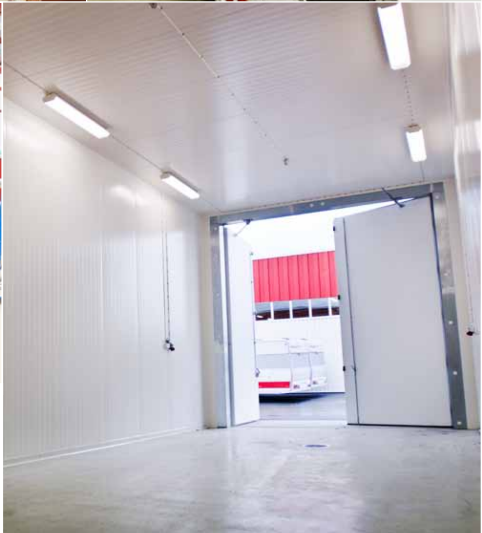
Mikael Blomqvist, technischer Leiter bei KABE, zeigt die in der Branche einzigartige, enorme Kältekammer, in der Wohnwagen und Wohnmobile – sogar der 11 Meter lange Hacienda Platz hat – bei Temperaturen von -30^{\circ} bis zu +55^{\circ} C getestet werden. Oben: Vier separate Waagen sind fest im Boden montiert. In der Regenkammer werden Wohnwagen und Wohnmobile unter hohem Druck besprüht.
