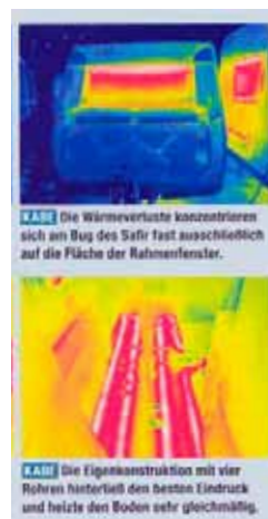
I det tyska testet kontrollerade man med värmekamera hur värmen spred sig i vagnarna.
