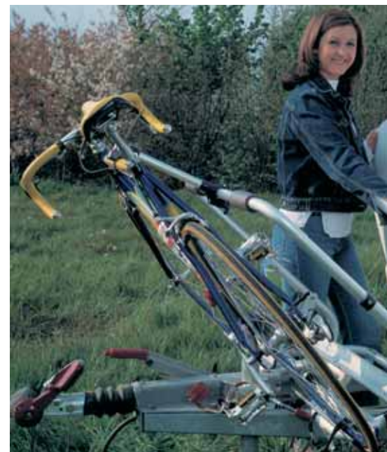
Cykelhållare finns både för montering på bakgaveln (ser tuffast ut) och på dragbalkarna (ger de bättre köregenskaper). Omni-Bike kan fällas framåt, även med cyklarna på, så att du kommer åt innehåll i gasolkofferten. Båda typerna av cykelhållare kostar drygt 1 600 kronor.
