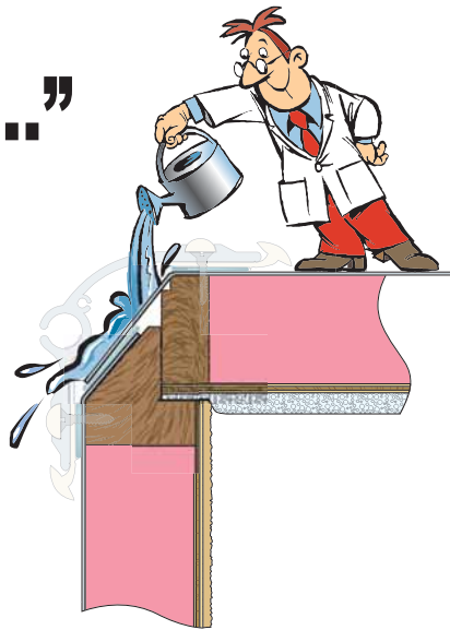
Mellan vägg och tak tätas det ytterst noggrant med butylmassa. Därefter viks takplåten omlott med vägglåten, för att omöjliggöra läckage.
