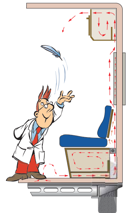
Vagnarna är byggda för att ge bästa möjliga luftgenomströmning, från golvet, under sängar och soffor och upp mot taket, genom de ventilerade överskåpen. Detta gör att Kabe är husvagnen som har den bästa och jämnaste värmefördelningen.
