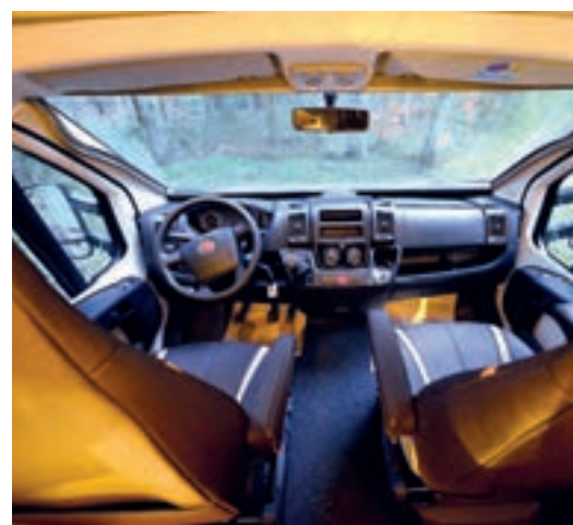
▲ Välutrustad kupé. Värmefläktar under stolarna och en matta med vattenburen värme på golvet.
