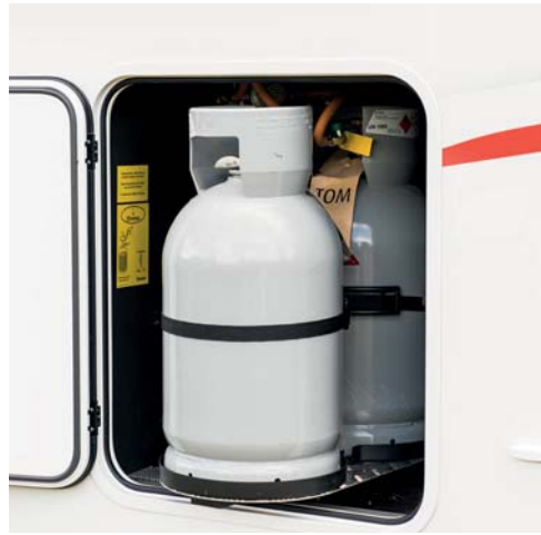
Kaasupullokotelossa kääntölevy, joka helpottaa raskaiden kaasupullojen käsittelyä.
