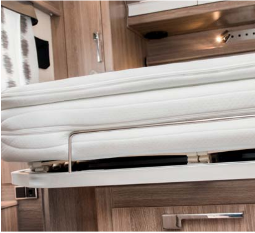
Tuki, joka estää parisängyn patjaa luistamasta alaspäin, kun käytät sängyn korotettavaa pääpuolta.
