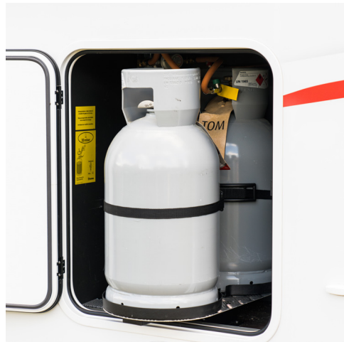
Gasflaschenraum mit Drehplatte.
