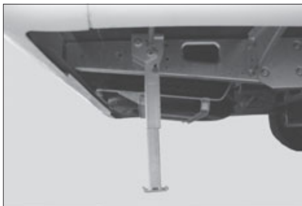
Stödbenet nervevat för att stabilisera husbilen.
