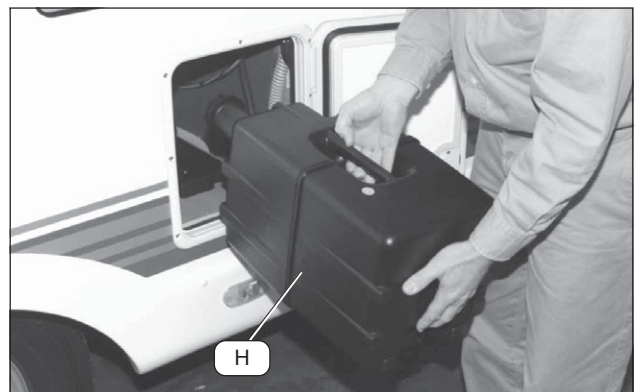
Vedä jätessäiliö suoraan ulospäin ja nosta sitä kahvasta.
