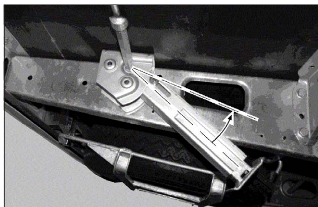
Tukijalka on veivattava perille saakka yläasentoonsa.
