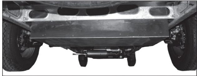
Harmaavesisäiliö on matkailuauton takapyörien välissä.
